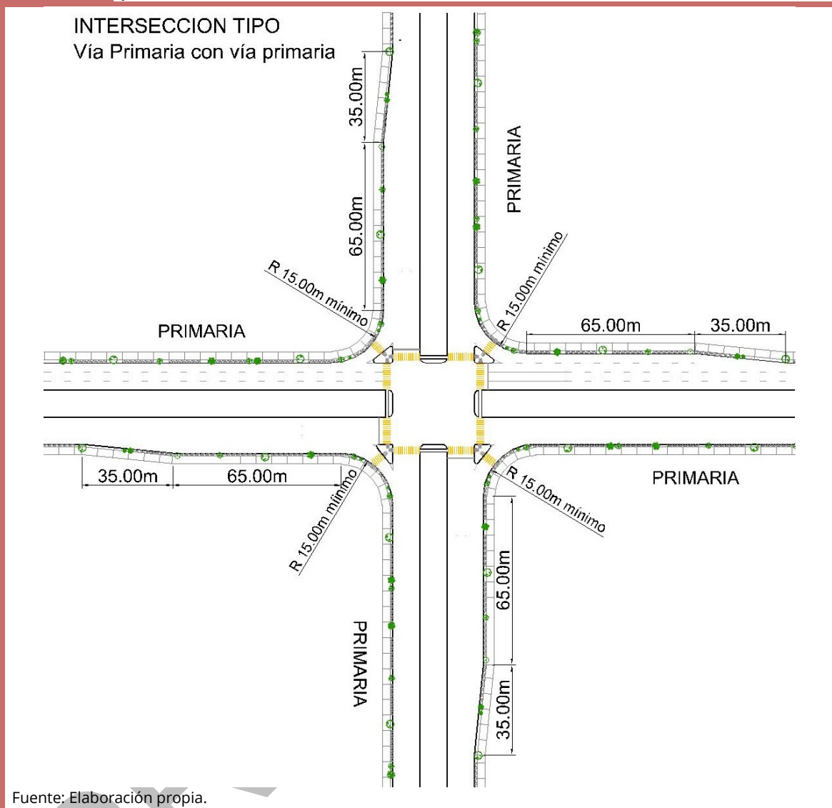
Imagen. Criterio general de diseño para intersecciones de vía primaria con vía primaria
